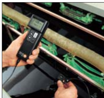
La tecnología del electrodo de 4 polos evita la formación de recubrimientos físicos que distorsionan los valores medidos ej. aguas residuales
